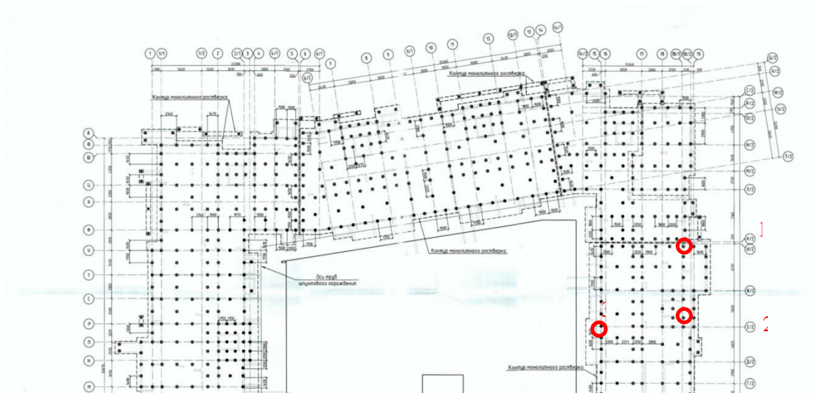
Рис 4.2.1. Схема расположения свай 1-3.
