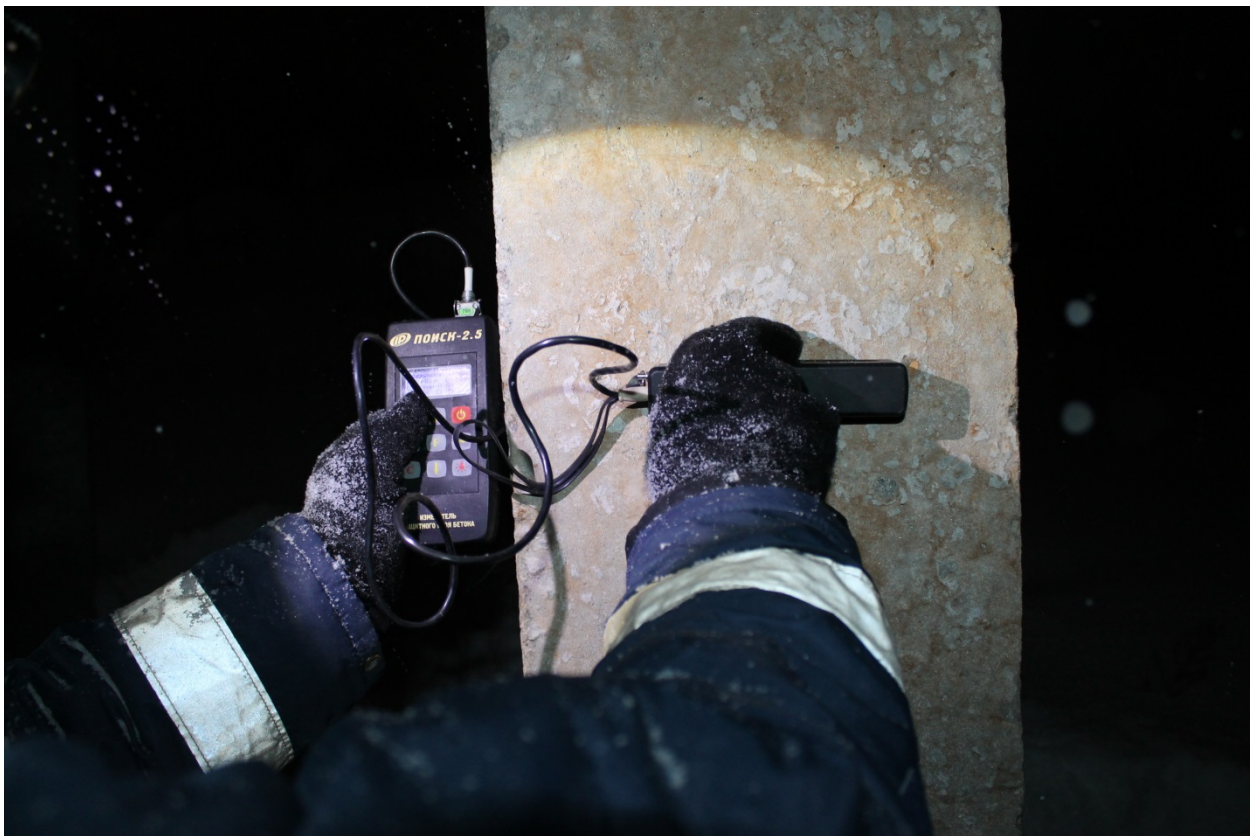
П. 7.11 Определение защитного слоя магнитным методом
