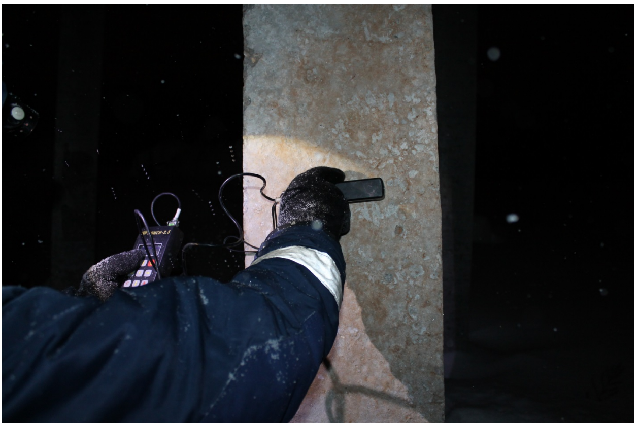
П. 7.10 Определение защитного слоя магнитным методом
