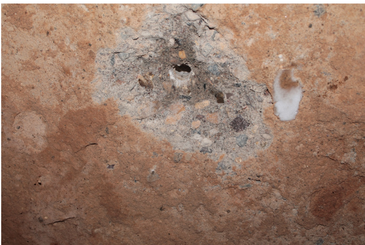
П. 7.4 Испытание стены методом отрыва со скалыванием
