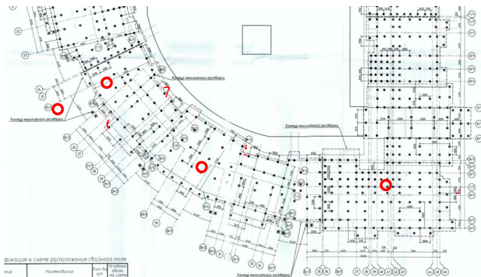
Рис 4.2.2. Схема расположения свай 4-7.
