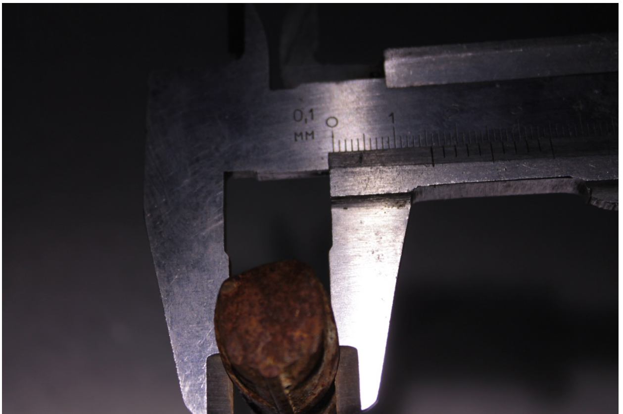
П. 7.5 Обмер диаметра арматуры
